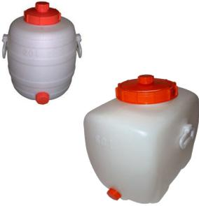
Alle Vorratsbehälter, je nach Größe, rund oder oval, ungefärbt aus Niederdruck-Polyäthylen mit Tragegriffen, Weithalsdeckel, Verschlussdeckel und Restmengenauslauf. 20 Liter Behälter mit Schraubanschluss passend zur Pumpe 11.0.1005 (Maße: Durchm. 310 mm, 418 mm Höhe). Bei den Behältern 60 und 200 Liter ist der Deckel so ausgeschnitten, dass die Pumpe 9.8.1005 eingebaut werden kann.
